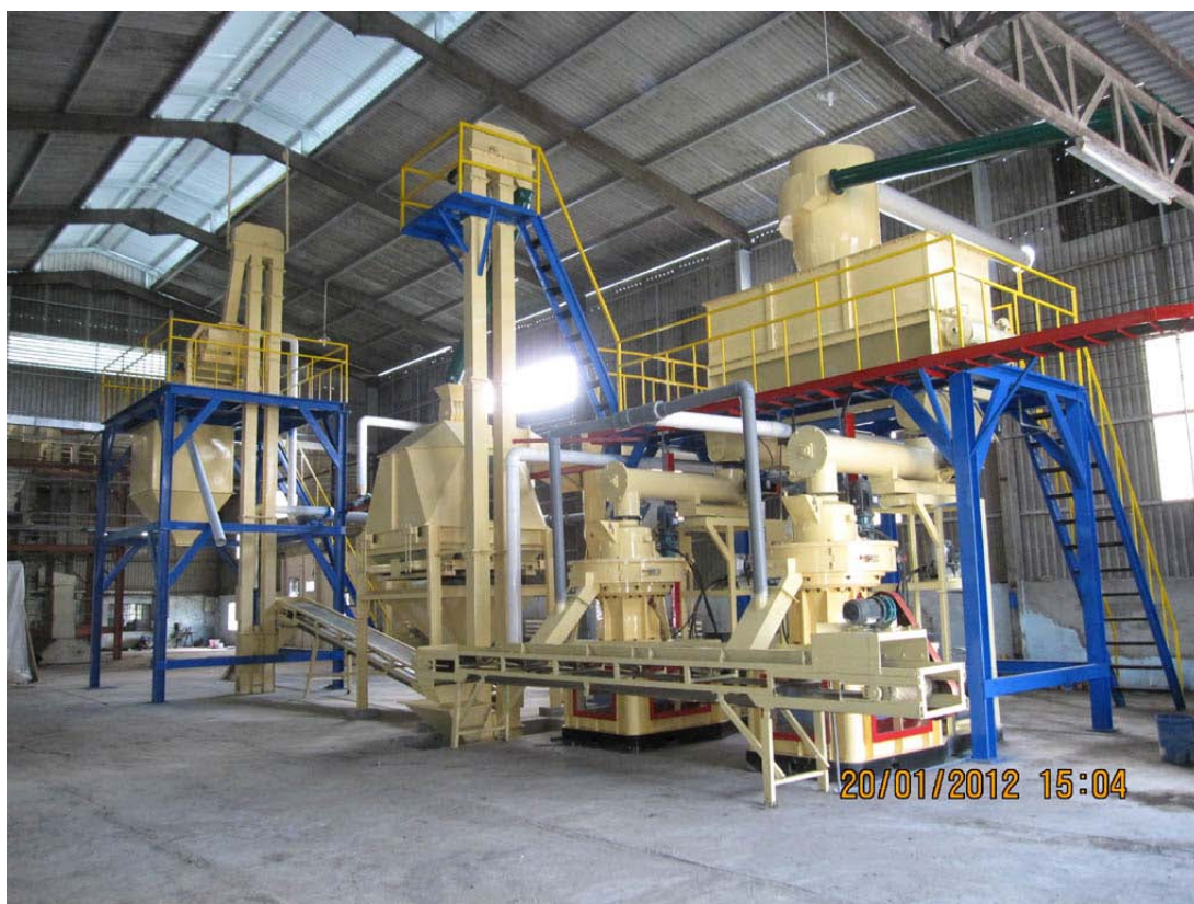
Slika 1.5. Linija za peletiranje drvene biomase kapaciteta 2-3 t/h [22]
