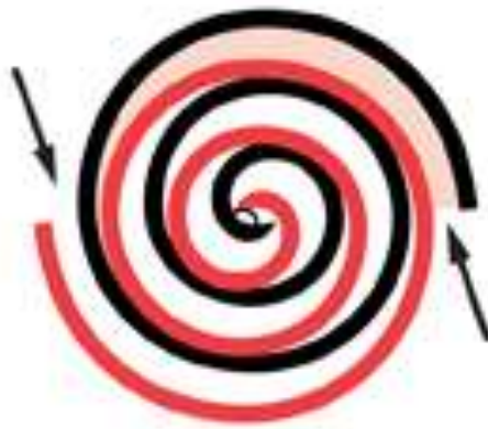
Slika 3.3. Princip rada spiralnog kompresora
