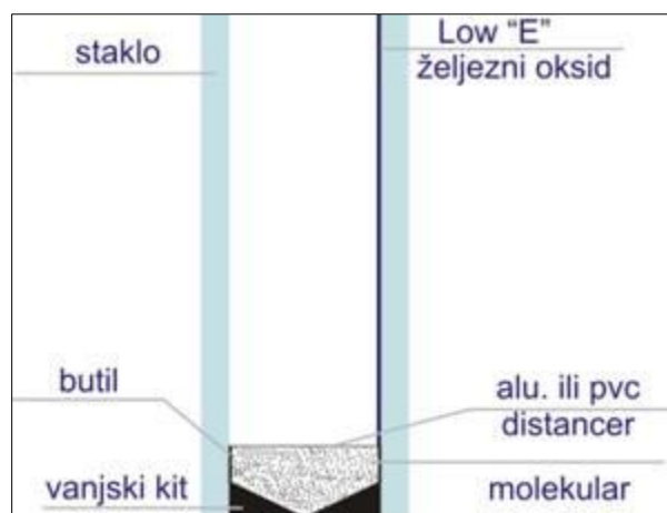
Slika 8 Struktura dvostruko izolirajućeg stakla s jednim staklom niske emisije (jedna Low-E obloga)
